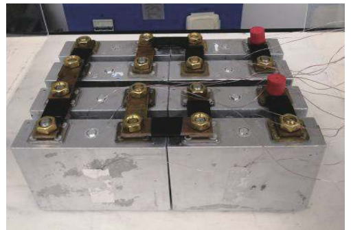
图3 自然冷却的电池模组
