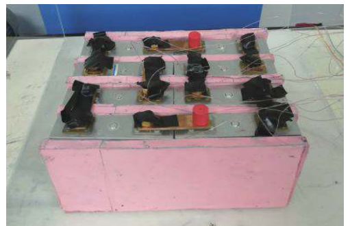
图5 PCM冷却方式的电池模组
