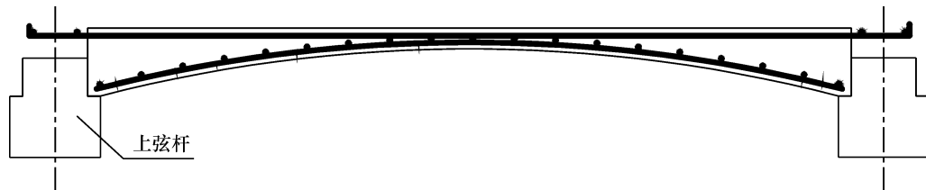
图 2 上平下拱少筋微弯板示意图
