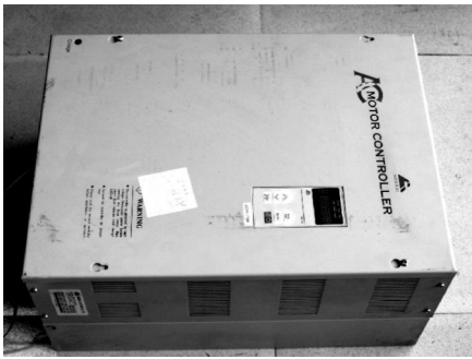
图 4 压力机的交流伺服驱动控制器
